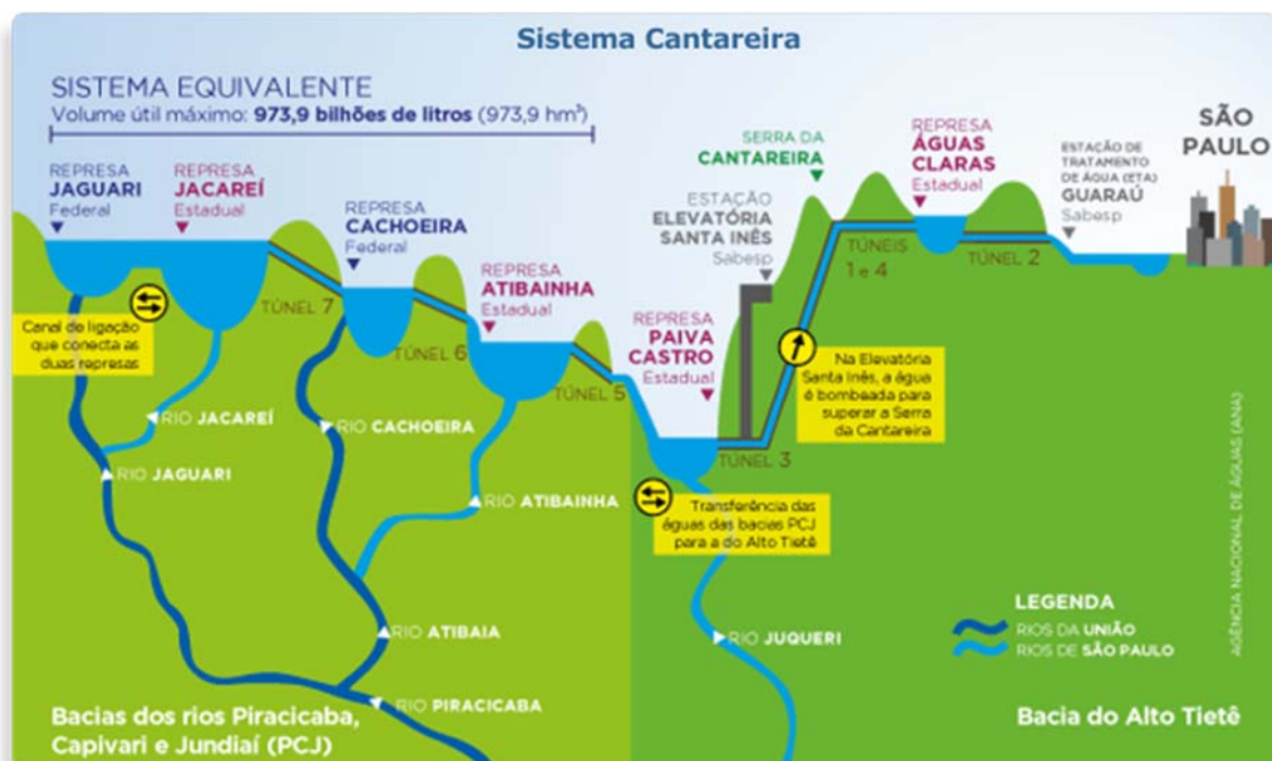
Figura 23: Representação esquemática do funcionamento do Sistema Cantareira
