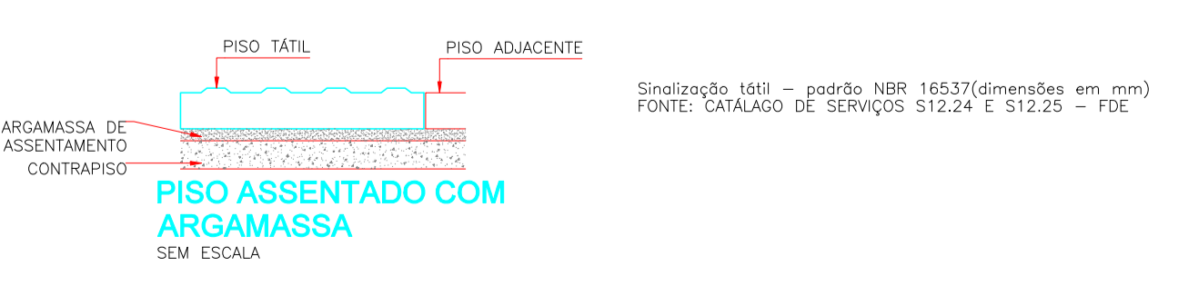
PISO ASSENTADO COM ARGAMASSA SEM ESCALA
