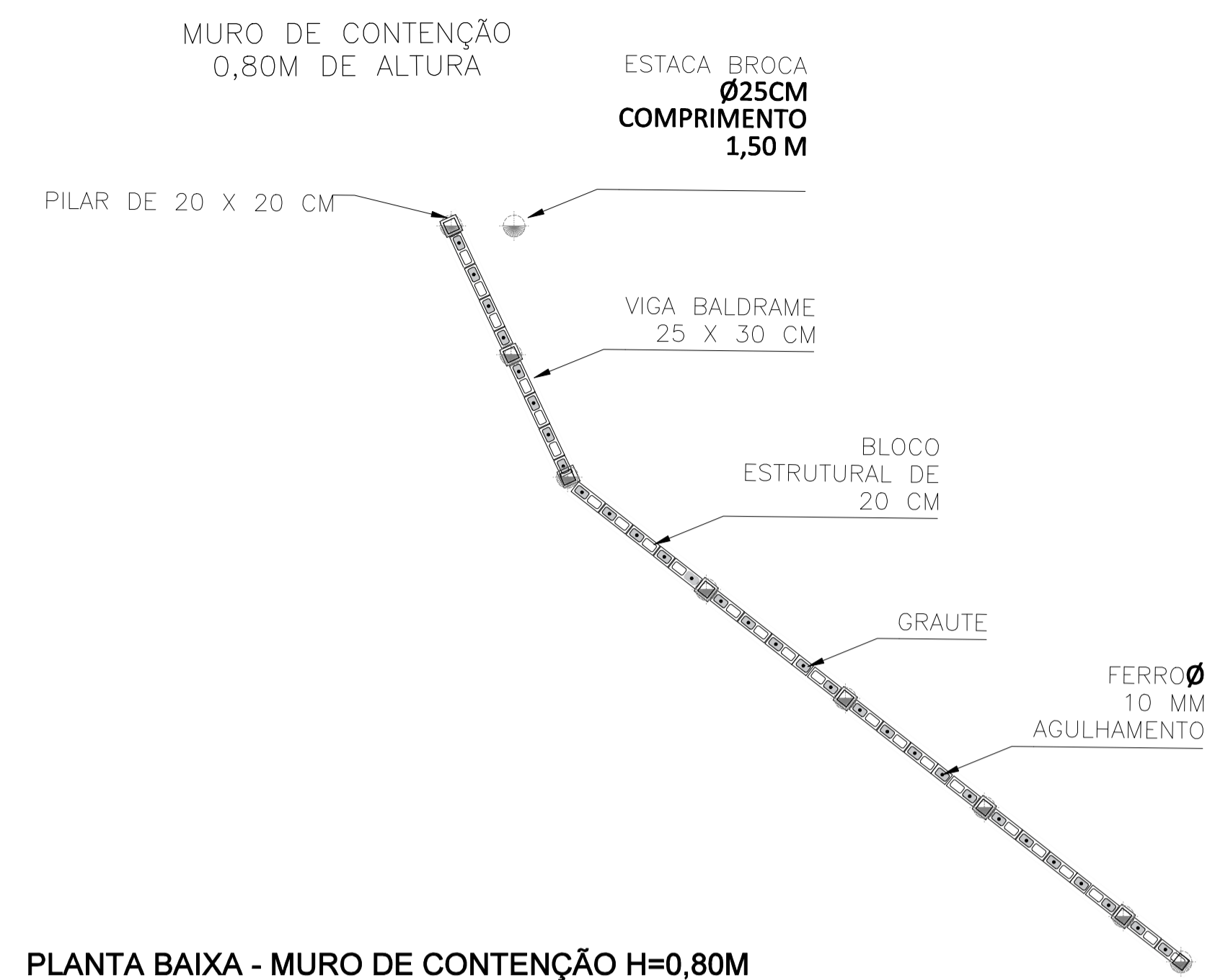
PLANTA BAIXA - MURO DE CONTENÇÃO H=0,80M
