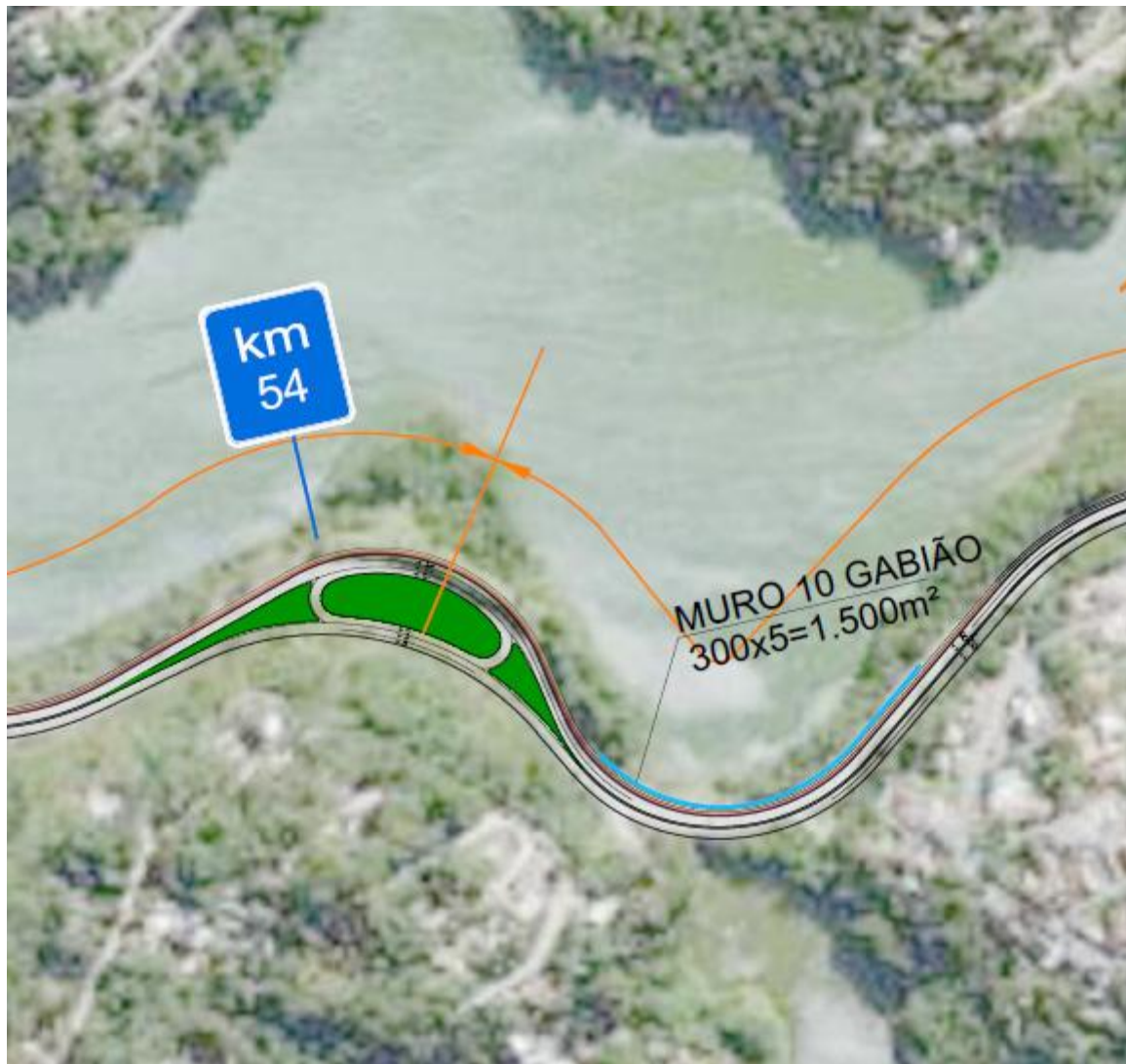
Aproximação do objeto – Rotatória Recanto do Lago Rod. Pref. Luiz Salomão Chamma – km54
